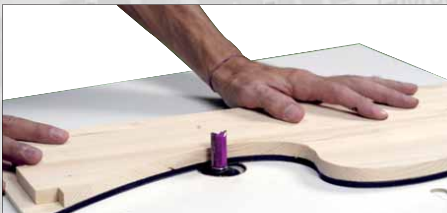
Photo n° 8 : découpe d'un panneau à l'aide du gabarit S Attention : protecteur enlevé pour une meilleure clarté de la vue.
