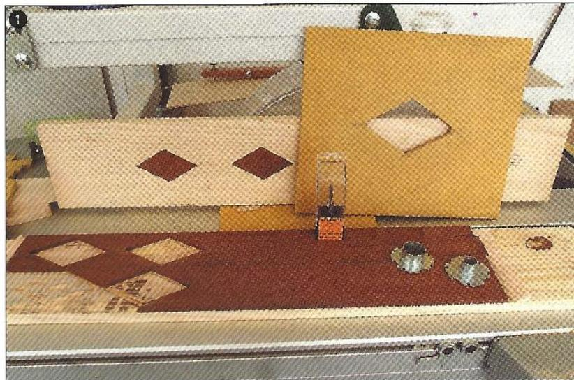
scie sauteuse, la courbe des contours doit être lisse et sans défaut et les chants perpendiculaires à la surface.
