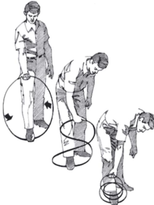
**Figure 12 Pliage d'une lame en 3 boucles**
