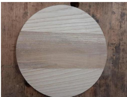
Le socle est composé de trois pièces de frêne, assemblées à plats joints renforcés par des lamellos. Le cercle est découpé à la défonceuse
