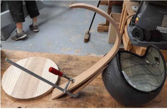
Le support et le socle sont protégés par une couche de cire incolore appliquée à chaud. L'excédent est ensuite retiré avec de la paille de fer 4/0 puis poli avec un chiffon doux. Le support est ensuite collé et vissé au socle.
