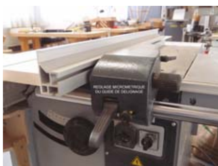
Micrométrie pour délimiter à largeur
