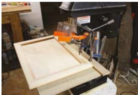
Percement de l'emplacement des barreaux dans le plateau puis vérification.
