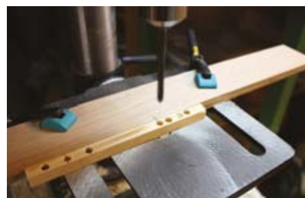
Centrage du perçage et réglage de la profondeur
