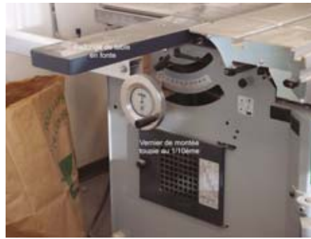
Rallonge de table en fonte pour la scie et la toupie et vernier au 1/10 ème
