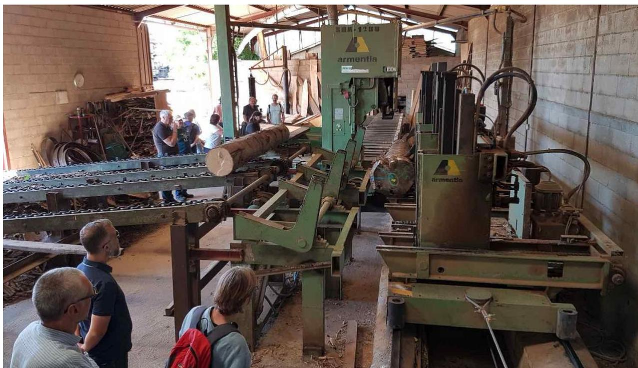
Le banc de scie en action. A gauche, le convoyeur d'alimentation des grumes, à droite le chariot qui tient la grume et la présente à la lame de scie, au centre la scie à ruban et au fond le convoyeur d'extraction.
